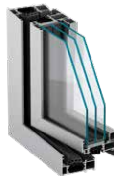
MB-79 Głębokość ramy 70 mm. System okiennie-drzwiowy, elastyczny dla różnych wymagań, U_w od 0,83 W/m 2 K.
