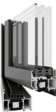
TM-77 Głębokość ramy 77 mm. System okiennie-drzwiowy, kopartybilny dla różnych wymagań i systemów np. tarasowych, U_f od 0,80 W m 2 K.
