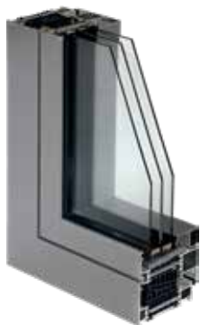
MB-104 Głębokość ramy 95 mm. System do budownictwa pasywnego, U_w od 0,53 W/m 2 K.
